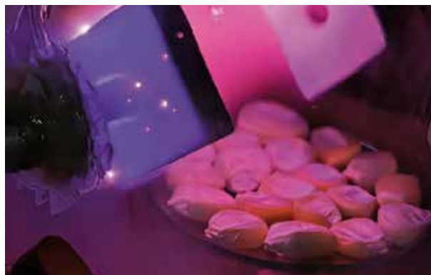
Tratamiento de semillas de maíz con plasma de aire.
