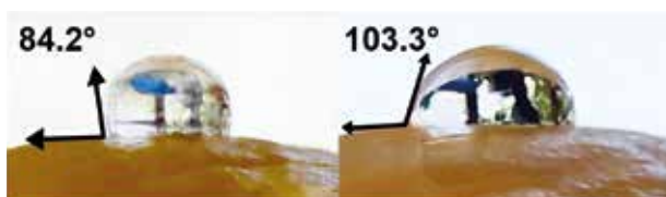
Ángulos de contacto distintos entre semillas de aguacate y una gota de agua.
