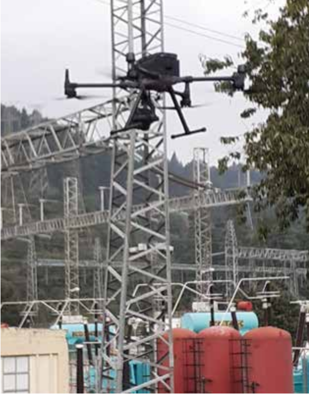
Dron para inspección de redes de transmisión – DJI Matrice 300.
