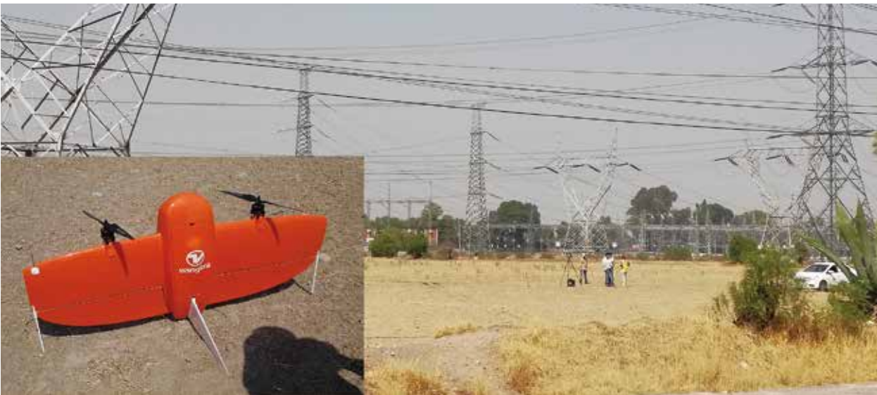
Dron VTOL Wingtra de despegue vertical y vuelo horizontal – Inspección de redes eléctricas.
