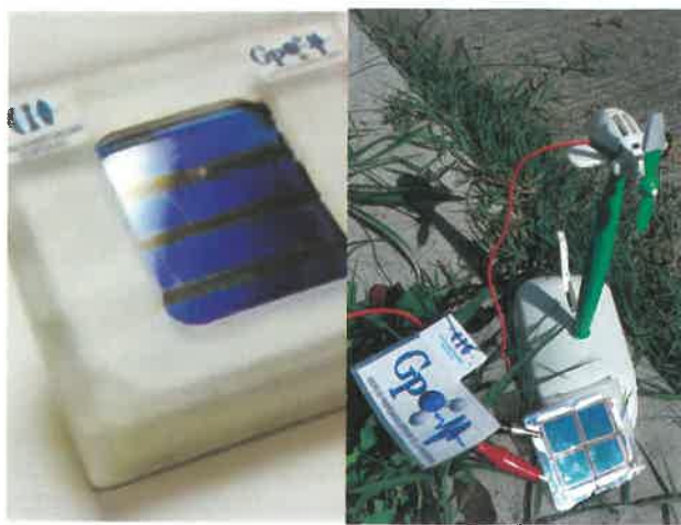
Figura 2. Prototipo de panel solar basado en celdas OPVs del GPOM CIO. Alimentación eléctrica de un motor con prototipos de OPVs, ver video: https://docs.google.com/file/d/0B0Ah1sti5-XAY2kzeExtraXVGVWWM/edit
