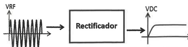
Figura 2. Extracción de energía a partir de un enlace de RF.
