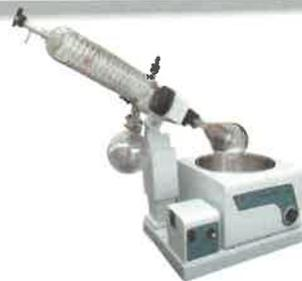
Figura 3. Uno de los equipos utilizados para obtener los extractos de las plantas que están siendo evaluadas es el rotavapor.
