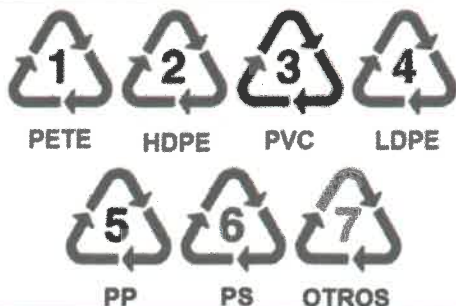
Figura 2. Sistema de codificación de los Desechos Poliméricos 8
