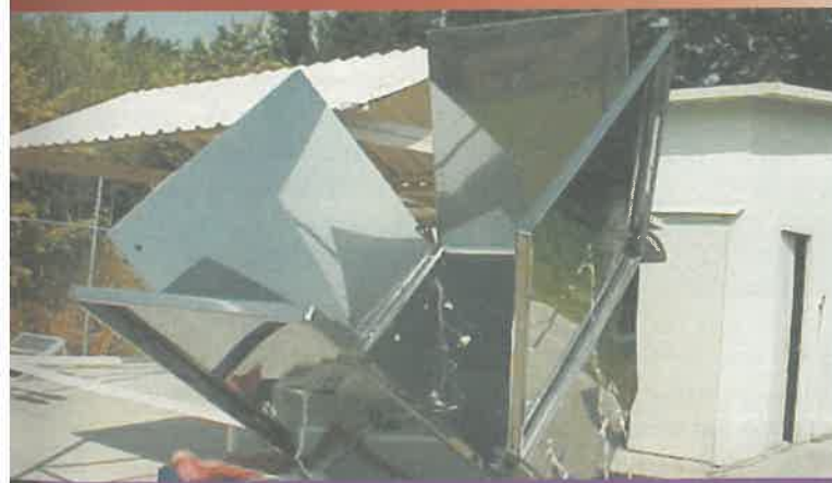
Figura 1. Horno solar tipo caja (Cortesía de la Dra. Guadalupe Huelsz Lesbros, CIE-UNAM).
