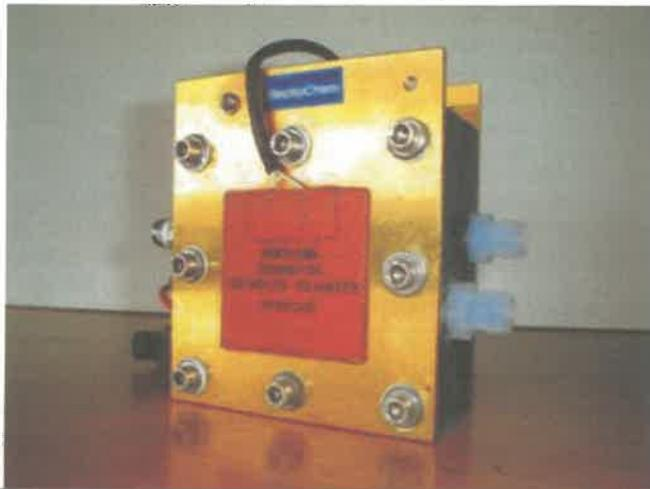
Fig. 1 Monocelda de combustible PEM, marca ElectroChem Inc. (Propiedad del Instituto de Investigaciones Eléctricas, IIE, Autor: Zamora A.)
