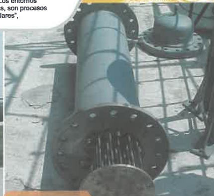
Vista interior del reactor-sólido gas del refrigerador termoquímico cloruro de bario-amoníaco
